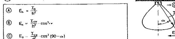
6 Principe de distance photométrique.
